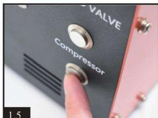
**ATTENTION!** Faites toujours fonctionner le ventilateur de refroidissement avant de démarrer le compresseur.
