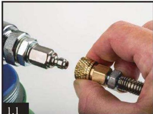
2) Connectez l'autre extrémité du Foster à la sortie située à l'avant du compresseur via un raccord mâle. Assurez-vous que le raccord Foster est bien serré.
